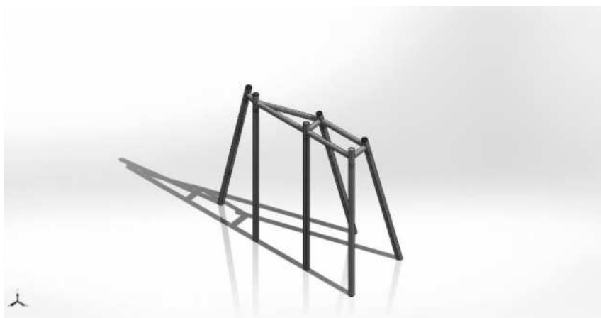
Figura 2 – Estacas e travamento lado esquerdo.
