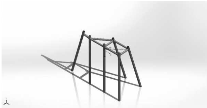
Figura 2 – Estacas e travamento lado esquerdo
