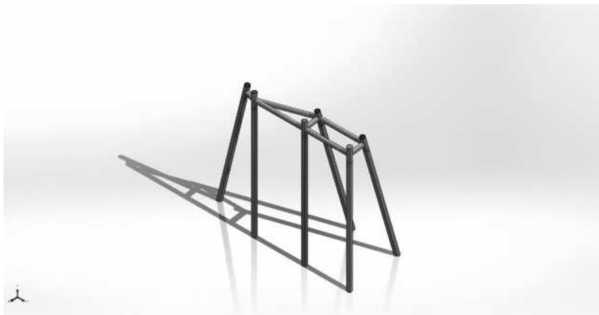
Figura 2 – Estacas e travamento lado esquerdo.
