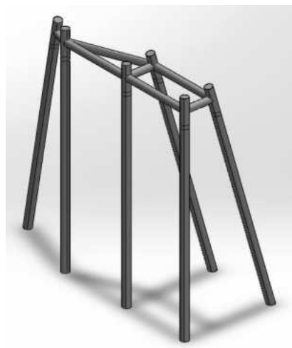
Figura 2 – Estacas e travamento lado esquerdo
